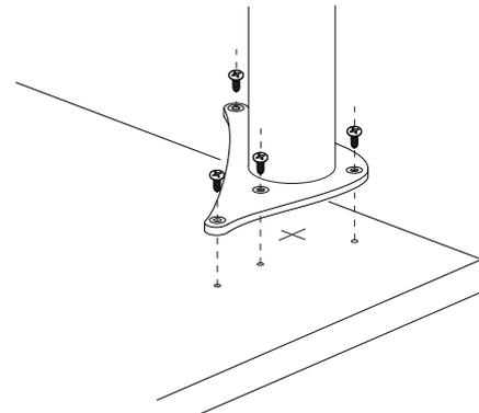
**1** Parafuse a base no tubo utilizando o parafuso M10x35mm.
