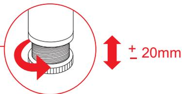
**3** Ajuste a altura e nível do móvel girando a sapata regulável.
